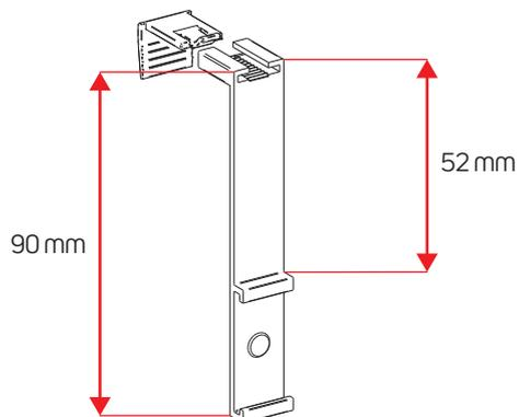
Lo spessore dell'anta della finestra per il supporto a morsetto deve essere compreso tra 15 e 23 mm.
